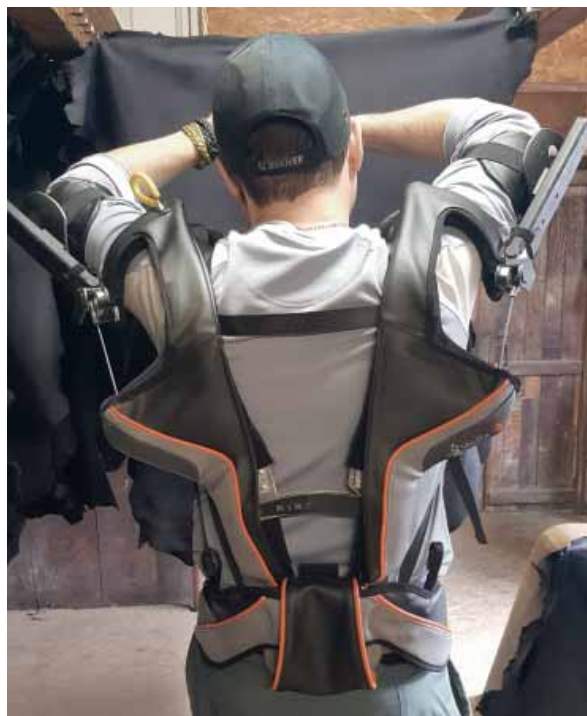
Exosquelette de maintien des bras en l'air IP12 modèle SkelEx, en test chez Bodin-Joyeux
