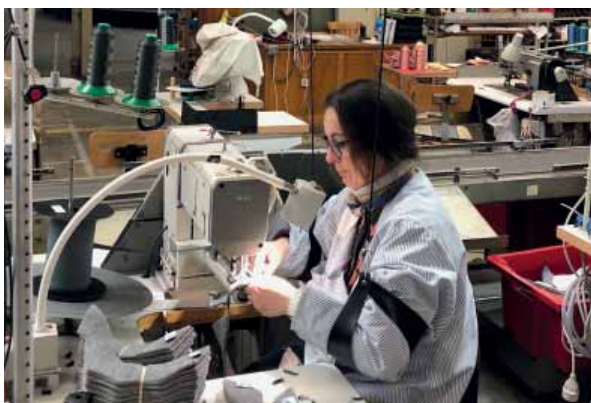
Harnais Libergo installé sur un poste de piquage Ströbel
