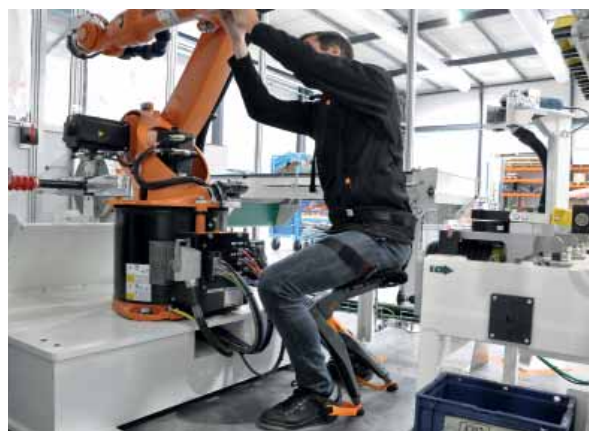
Exosquelette IP 14 permettant d'alterner une position assise ou debout
