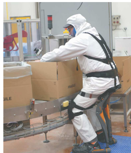
Le modèle d'ergosquelette pour les membres inférieurs (à droite) limite la fatigue liée à la position debout.
