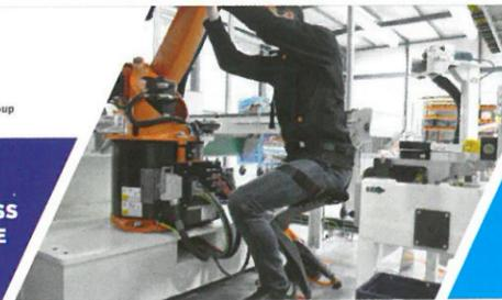
L'ergosquelette IP14 Chairless Chair® est un support ergonomique portable, léger flexible pour les positions d'assises, penchées ou demandant une alternance assis-débout.
